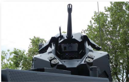
Тој 25 mm са сјрегнућим мишраљезом 7,62 mm у даљински управљаној станици на возилу Мк 3
