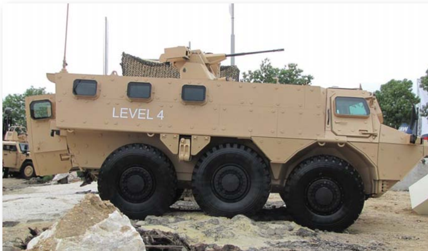
Возило VAB Mk2 са нивоом заштите и борбеном станицом на крову с топом 25 милиметара
